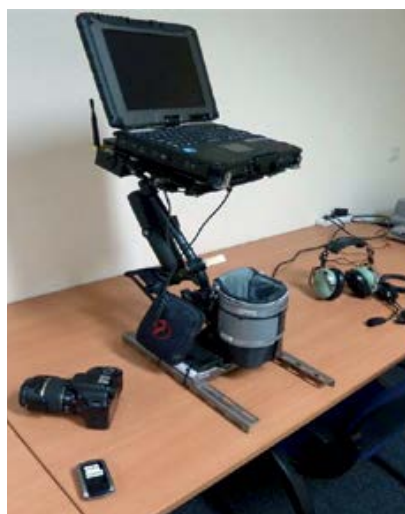
Het boordsysteem waarover iedere RWS-luchtwarnemer kan beschikken tijdens de vlucht.
